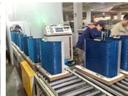
家用空调生产线
