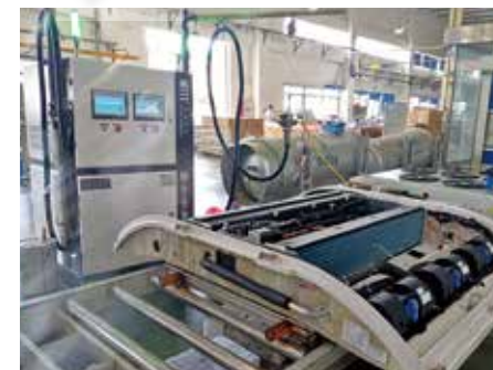
轨道列车空调产线
