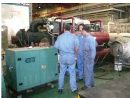
中央空调生产线冷媒回收
