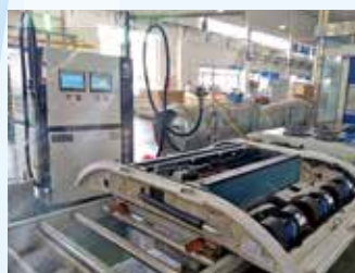
轨道列车空调生产线 Train A/C Assembly Line
