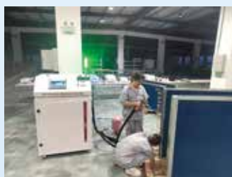
热管加注机 Heat Pipe Assembly Line
