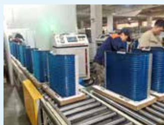
家用空调生产线 Split A/C Assembly Line
