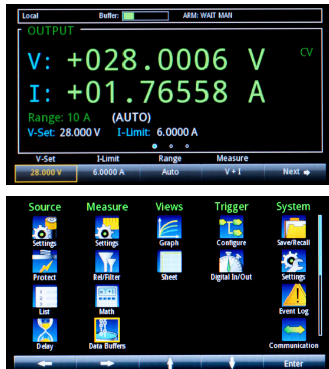
图3 通过主屏调整电压、电流、电流量程、测量模式、保护等级和其他功能。
