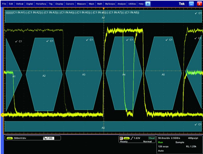
布尔逻辑触发判定。使用逻辑关系 OR 的布尔逻辑允许用户同时监测每个位，捕获采集中任何点上发生的异常事件。
