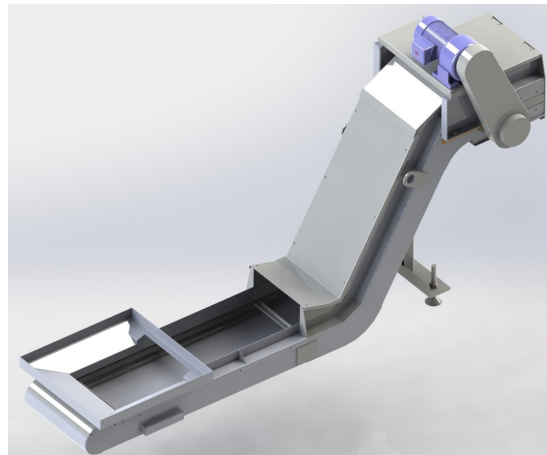
Схема стружкоотводчика (опция)
