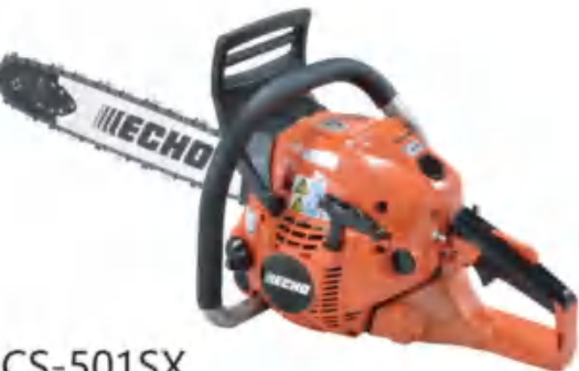
CS-501SX 排量: 50.2cm³ // 功率: 2.57kW / 3.50ps // 净重¹: 4.7kg // 导板尺寸: 40, 45, 50cm / 16, 18, 20in
