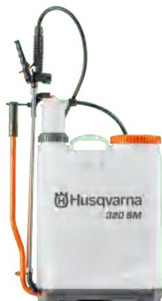
320SM 是一款多用途的背负式手动喷雾器, 可以满足小型农场和市政园林的喷雾工作。喷嘴可调。通过旋转喷嘴可以喷出直线水柱, 锥形水面, 或调成喷雾状态。喷杆长 50cm, 在 3bar 的压力下喷头流量可达 800ml/min。配有双肩背带, 背带内有衬垫, 胸前有卡扣, 舒适, 省力, 让每一天的工作变得轻松自如。
