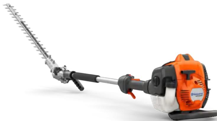
富世华 525HE3 高枝绿篱机专为专业用户设计。发动机 25CC, 刀片长度 60CM, 切割速度快, 刀片角度可在 135°范围内调节, 工作高度 3 米, 可同时适合高低绿篱的修剪。发动机还具有平衡块的作用, 使整个机器具有良好的平衡性能, 使用起来极其舒适。发动机底部装有缓冲支座。简易直观的操控方式使机器启动起来相当容易。刀头可以折叠运输。
