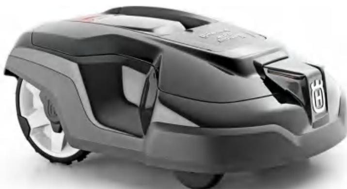
全自动割草机器人。安静, 零排放, 7天24小时自动工作, 切割效果好, 可爬坡度40%, 可在雨天工作, 工作面积1500m<sup>2</sup>。
