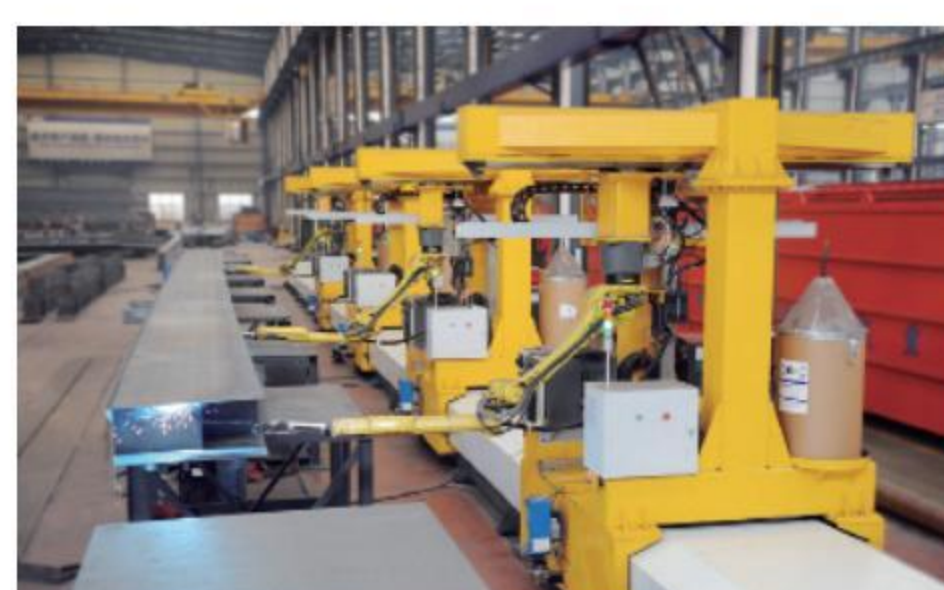
全自动双梁主梁内缝焊接机器人 Automatic welding robot for inner seam of double girder
