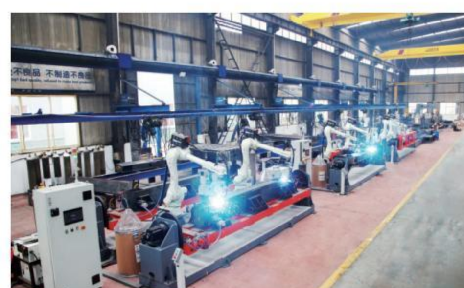
端梁焊接机器人 End beam welding robot
