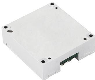
Шестиосевой инерциальный измерительный блок MEMS состоит из трехосевых микросхем гироскопа MEMS, микросхем трехосевого акселерометра MEMS, датчиков температуры, схем цифровой обработки сигналов, структуры и программного обеспечения. Он используется для измерения трехосевой угловой скорости и линейного ускорения носителя в режиме реального времени. Он совместим с продуктами серии ADIS16495.
