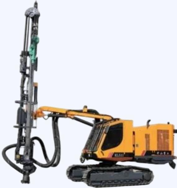
Установка KL511 предназначена для бурения вертикальных, наклонных и горизонтальных шпуров диаметром 76–127 мм. Применяется при дорожных работах, прокладке трубопроводов, строительстве фундаментов и на открытых горных разработках. Комплектация стандартными штангами. Установка оснащена штангами диаметром 45/51 мм, что обеспечивает высокую производительность при бурении в сложных условиях.
