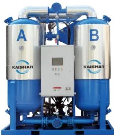
Осушитель с продувкой и подогревом относится к классу адсорбционных осушителей с регенерацией при подогреве. Принцип его работы заключается в том, что вентилятор забирает окружающий воздух, который затем нагревается и используется для регенерации адсорбента в адсорбционной колонне. Такой подход полностью исключает потери сжатого воздуха на этапе подогрева, характерные для осушителей с микроподогревом.
