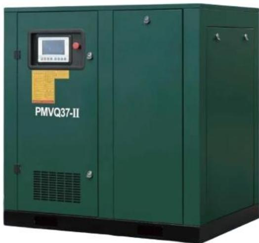
Компрессор PMVQ37-II оснащён новой горизонтальной двухступенчатой конструкцией с масляным охлаждением, обеспечивающей более эффективное межступенчатое охлаждение и значительное повышение эффективности сжатия. В сочетании с высокоэффективной системой частотного регулирования на базе двигателя с постоянными магнитами компрессор обеспечивает широкий диапазон регулирования и стабильную подачу воздуха.
