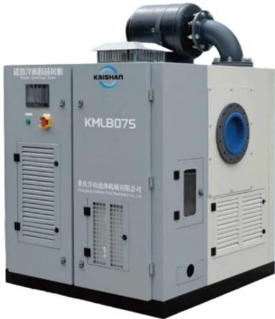
Магнитно-подвешенный центробежный нагнетатель оснащён бесконтактным, не требующим смазки подшипником магнитной подвески и высокоскоростным двигателем с постоянными магнитами. Прямой привод высокоэффективного рабочего колеса устраняет недостатки традиционных нагнетателей и воздушных компрессоров: отсутствует трение, не требуется смазка, при запуске ротор сначала подвешивается, а затем начинает вращаться — это
