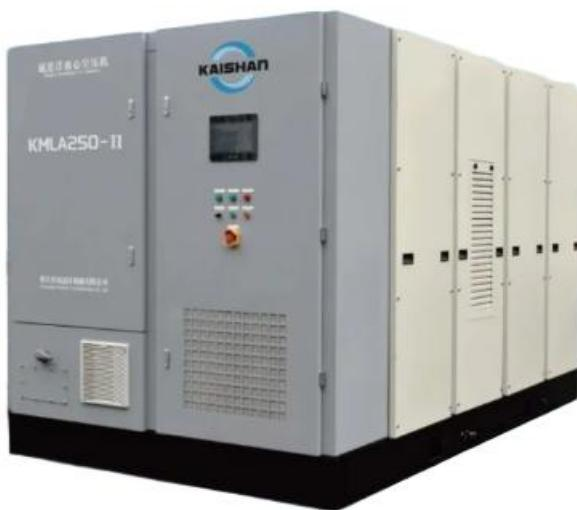
Компрессор нормального давления с магнитным подвесом работает в диапазоне давлений 6–9 бар. Это многоступенчатый центробежный компрессор с прямым приводом от высокоскоростного двигателя с магнитной подвеской. Обеспечивает абсолютно безмасляную подачу воздуха, не имеет механического трения, отличается высокой эффективностью и низким
