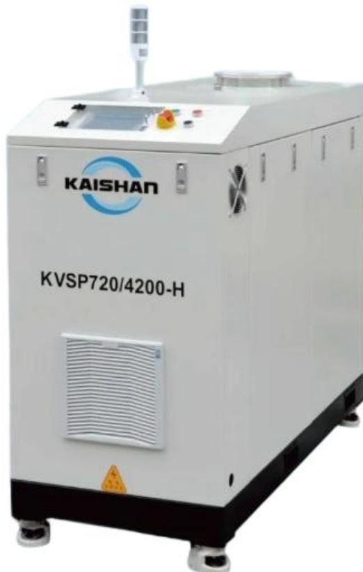
Вакуумная насосная установка с переменным шагом винта состоит из сухого винтового насоса и роторного насоса, соединённых последовательно. По сравнению с одноступенчатыми вакуумными насосами обеспечивает более высокий вакуум и большую производительность при меньшем энергопотреблении. Широко применяется в полупроводниковой, фотоэлектрической и литий-ионной промышленности.
