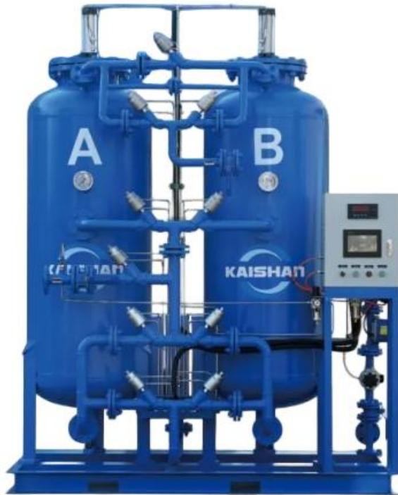
Технология PSA (Pressure Swing Adsorption — адсорбция при переменном давлении) представляет собой современный высокоэффективный метод разделения воздуха. В качестве исходного сырья используется сжатый воздух, а в качестве адсорбента — молекулярные сита. Установка производит азот или кислород за счёт циклического процесса адсорбции при переменном давлении.
