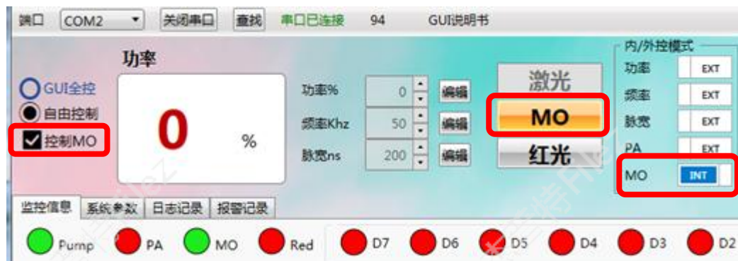
图 16 GUI 控制 MO 状态
