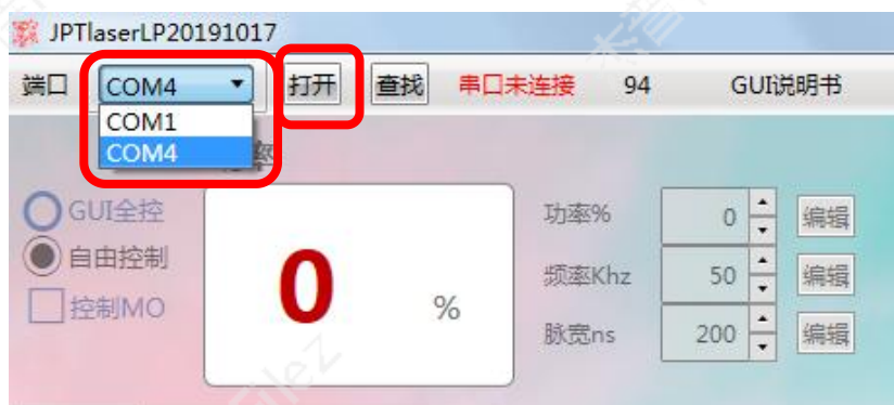
图 10 GUI 串口连接选择
