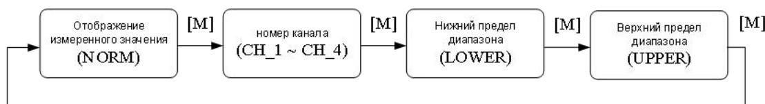
Рисунок 4.2 \_\_ Функция регулировки и ее ЖК-дисплей
