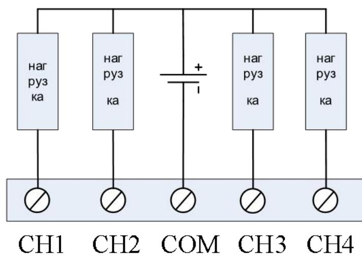
Рисунок 2.6 \_\_ Схема подключения FI 105
