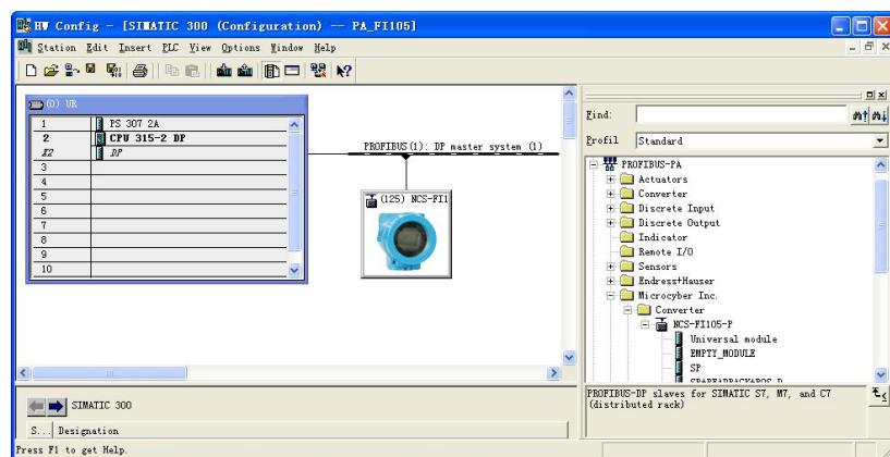
Рисунок 6.5 \_\_ Перетащите устройство РА на шину PROFIBUS DP.
