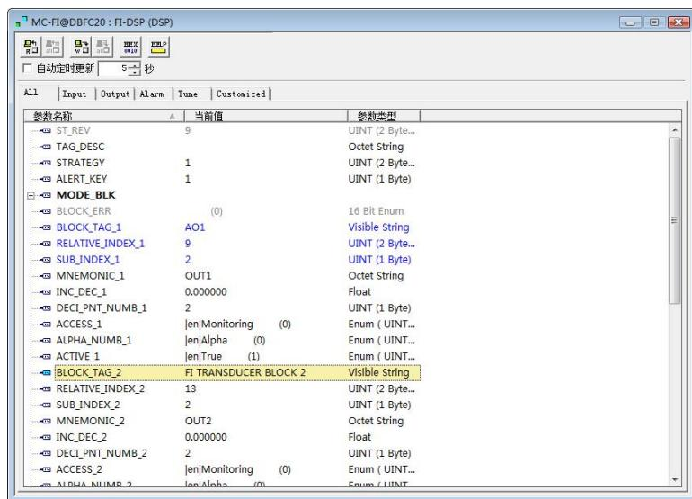
Рисунок 5.5 \_\_ Отображает конфигурацию параметров блока
