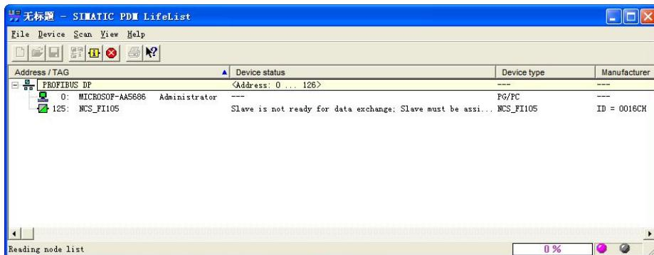
Рисунок 6.9 \_\_ Сканировать шину DP для получения списка устройств РА
