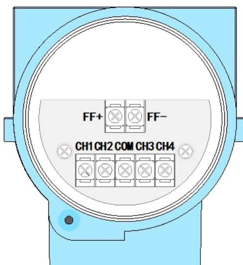
Рисунок 2.5 \_\_ Схема клеммной колодки преобразователя FI 105
