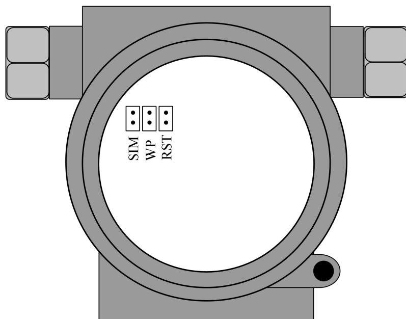
Рисунок 5.6 \_\_ Аппаратная перемычка преобразователя FI105
