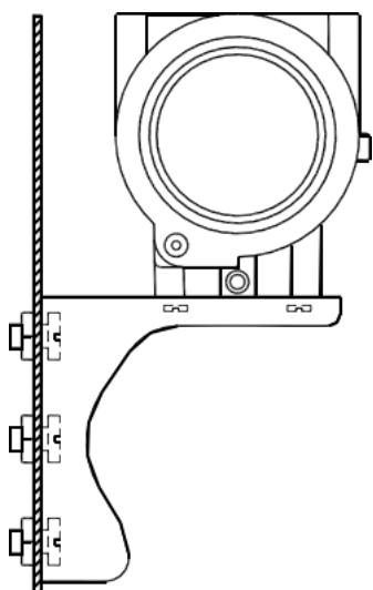
Рисунок 2.2 \_\_ Согните пластину кронштейна
