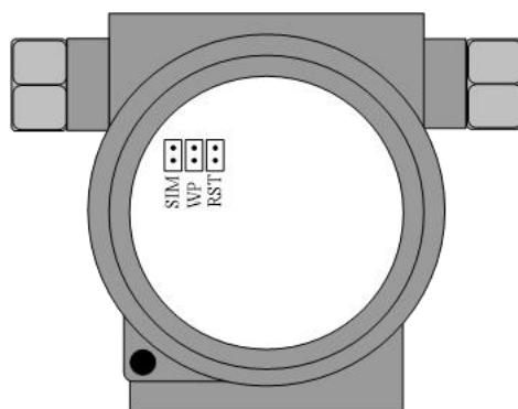
Рисунок 6.13 \_ \_ Аппаратная перемычка передатчика типа РА
