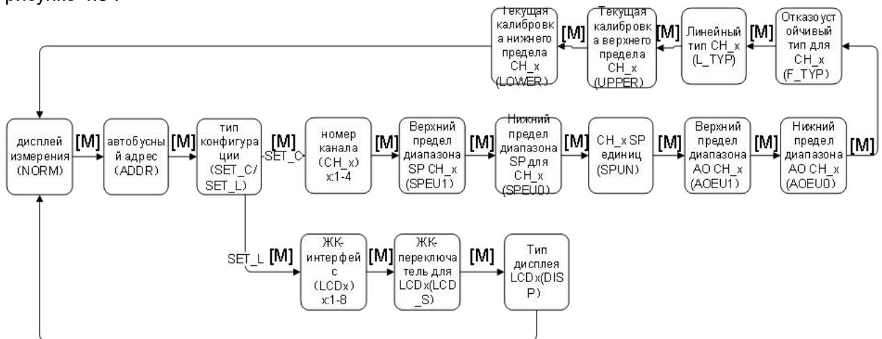
Рисунок 4.3 Схема переключения функций регулировки
