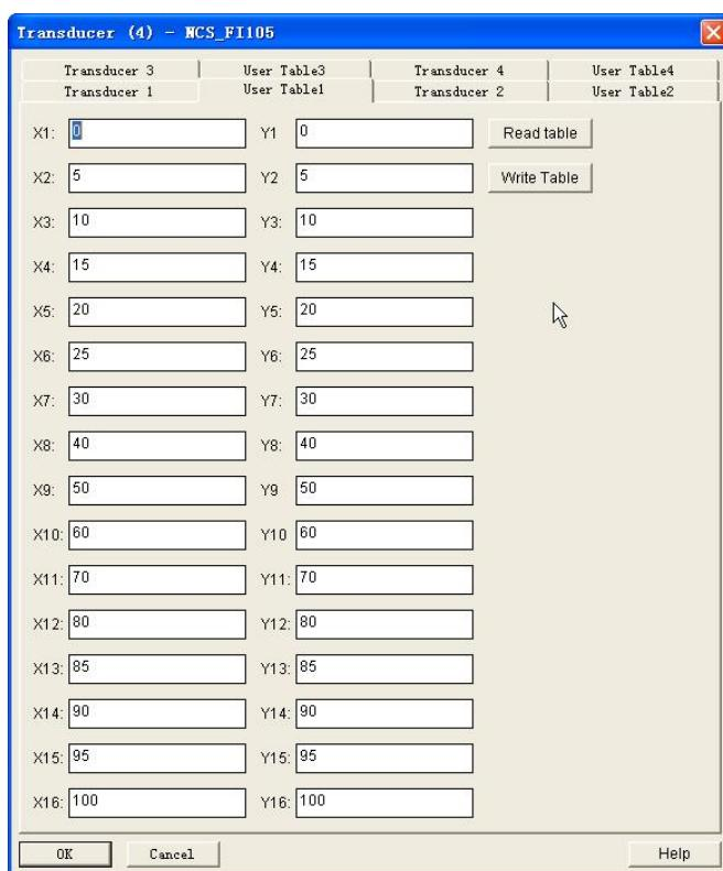
Рисунок 6.11 \_\_ Пользовательская многоточечная калибровка линеаризации
