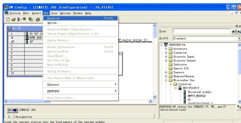
Рисунок 6.6 \_\_ Загрузить информацию о конфигурации в ПЛК
