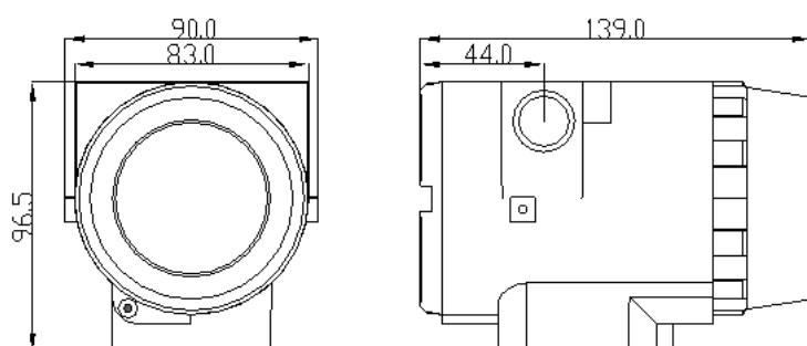
Рисунок 1.1 \_\_ Размеры преобразователя (единица измерения: мм)
