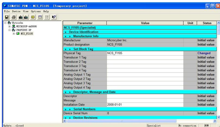
Рисунок 6.10 \_\_ Управление устройствами с помощью программного обеспечения PDM
