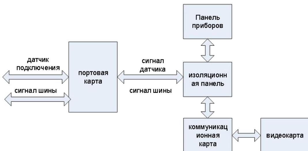
Рисунок 3.1 — Схема аппаратной структуры преобразователя FI 105
