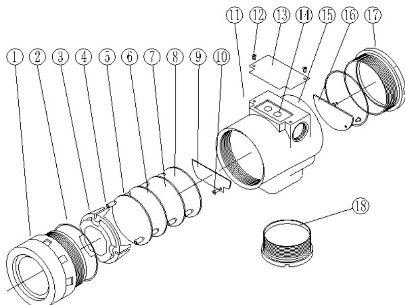
Рисунок 1.2 \_\_ Структура передатчика
