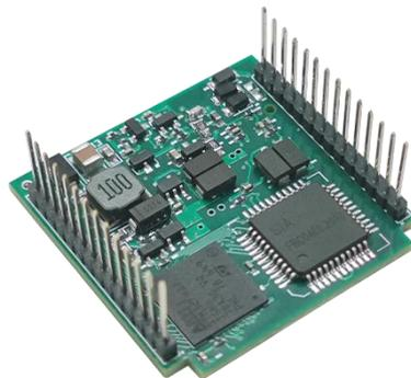
Рисунок 1.1 MC0307 Modbus to PA встроенный модуль основной платы
