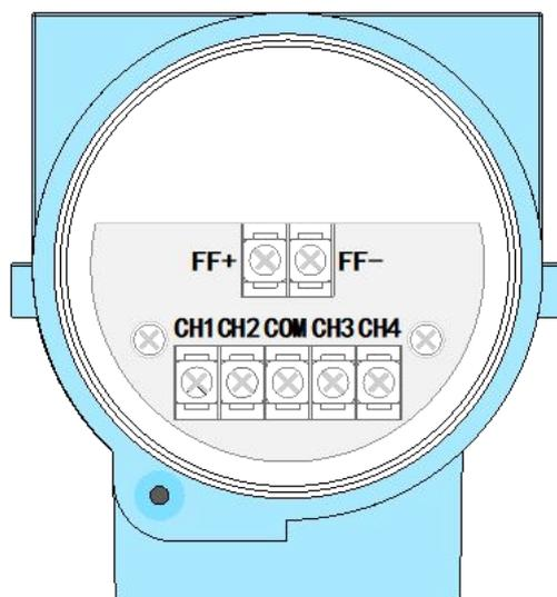
Рисунок 2.5 \_\_ Схема клеммной колодки преобразователя FI 105
