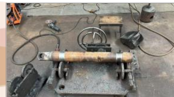
Выпрямление штока поршня Ремонт
