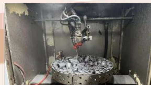
Очистка от ржавчины
