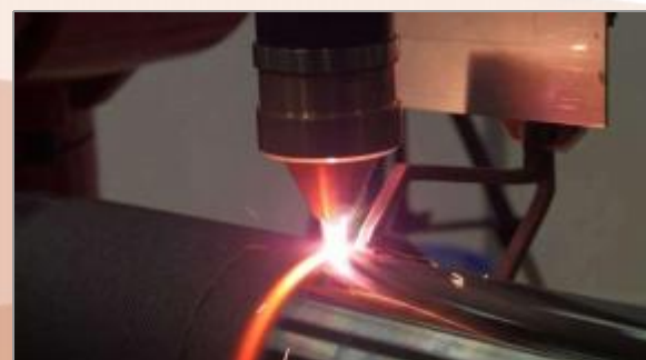
Высокоскоростное лазерное наплавление покрытия
